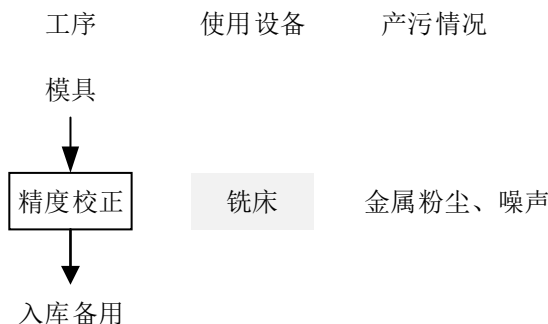
图4-2 模具维护工艺流程图
