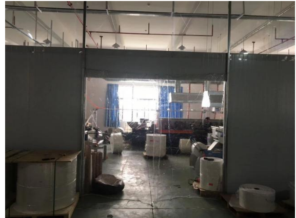
车间密闭设施
